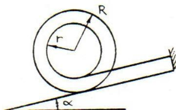
Eine Walze mit der Masse  $m$  wird durch ein auf dem Radius  $r$  aufgewickeltes Seil auf einer schiefen Ebene gehalten.
