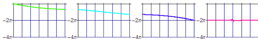
Phasenverlauf der Übertragungsfunktion H_k(s) über einen geschlossenen Weg A in der s-Ebene, a = 120
