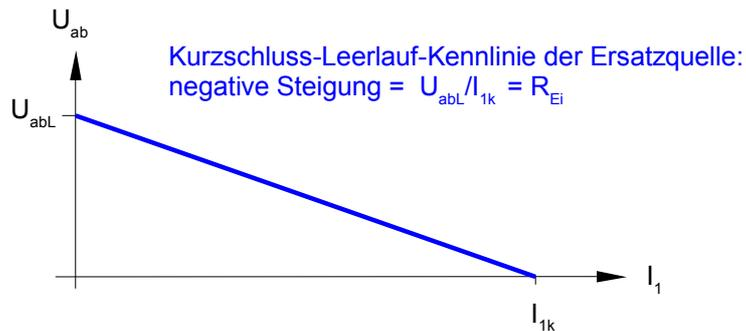
Hinweis: Wenn der an den Klemmen a, b angeschlossene Lastwiderstand  $R_L = 0$  ist (Kurzschluss), fließt durch  $R_1$  der Strom  $I_1 = I_{1k}$ , die Klemmenspannung  $U_{ab}$  wird 0. Ist dagegen kein Lastwiderstand vorhanden, sind also die Klemmen a, b offen (Leerlauf), so liegt an diesen die Leerlaufspannung  $U_{ab} = U_{abL}$ , es fließt kein Strom,  $I_1 = 0$ .
