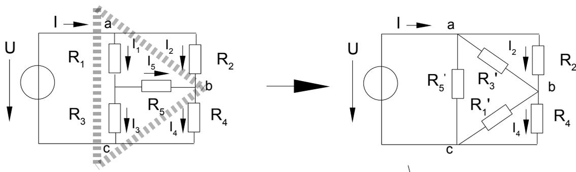
b)  $R'_5 = R_1 + R_3 + \frac{R_1 \cdot R_3}{R_5}$ ,  $R'_1 = R_3 + R_5 + \frac{R_3 \cdot R_5}{R_1}$ ,  $R'_3 = R_1 + R_5 + \frac{R_1 \cdot R_5}{R_3}$
